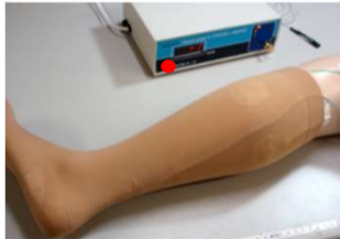
着用時のねじれや引き上げ方の違いが、測定値に左右します。 測定ポイントにマークや線を入れるなど工夫し再現性を高めると共に、
