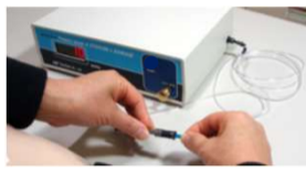
中継チューブとエアパックを接続、しっかり奥まで挿し込む(低い値を表示)
