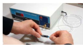
中継チューブとエアパックを接続、 しっかり奥まで挿し込む (接続完了時は、小さい値を表示)
