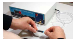
中継チューブとエアパックを接続、 しっかり奥まで挿し込む (低い値を表示)
